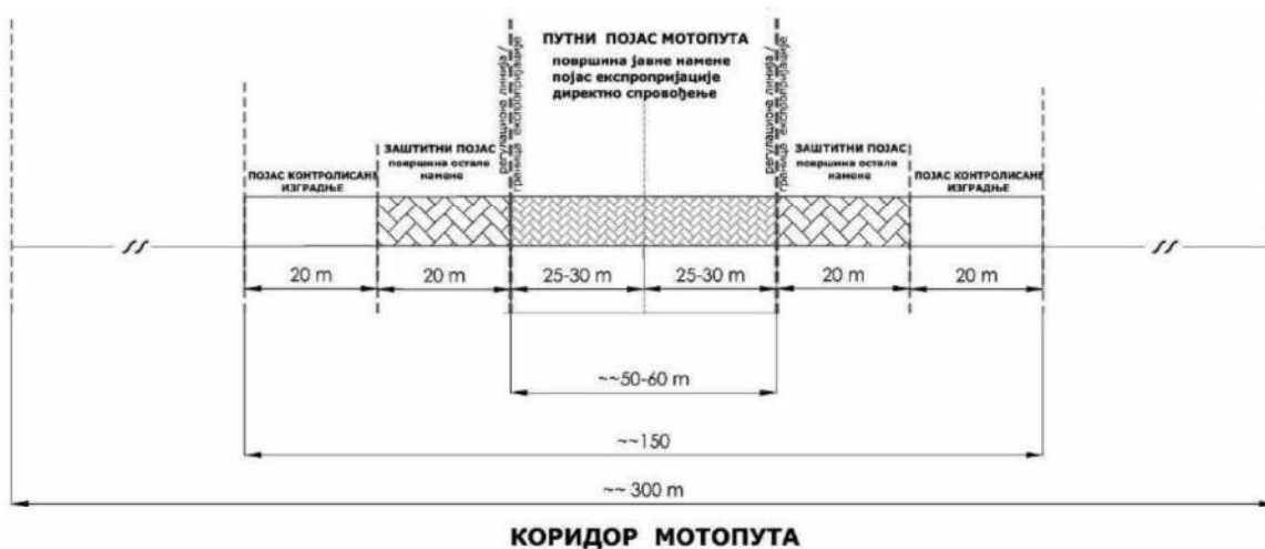
Слика 7: Шематски приказ попречног профила коридора мотопута
